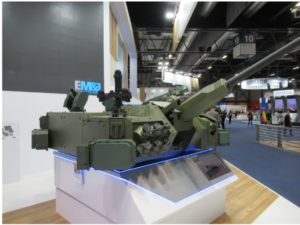
Escribanos RWS Guardian 30 mit maßstabsgetreuen Modellen der Iron Fist-Sensoren und -Effektoren, ausgestellt auf der jüngsten FEINDEF-Ausstellung (Autor)
