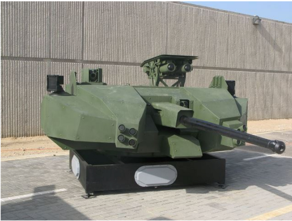
Erscheinung einer Variante des 30-mm-Samson-Turms mit dem Zwillings-Spike-Raketenwerfer und den Trophy-Effektoren. In diesem Fall wären die Radargeräte auf dem (Rafael-)Schiff montiert.
