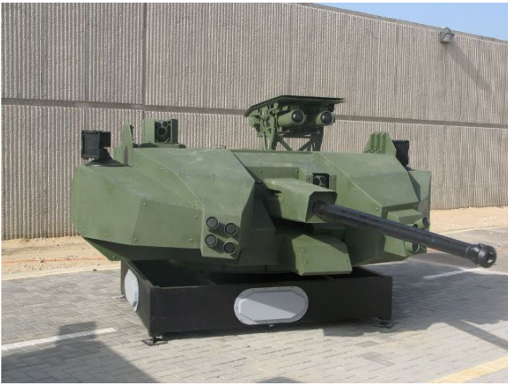
Aspecto de una variante de la torre Samson de 30 mm. con el lanzador doble de misiles Spike y los efectores del Trophy. En este caso los radares irían en la barcaza (Rafael)
